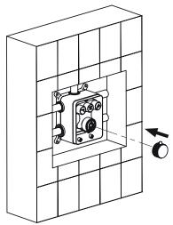
5. Запорными клапанами, установленными внутри смесителя по бокам (1-HOT и 2-COLD), вы можете отрегулировать или закрыть поток горячей и холодной воды в смеситель с помощью отвёртки.
