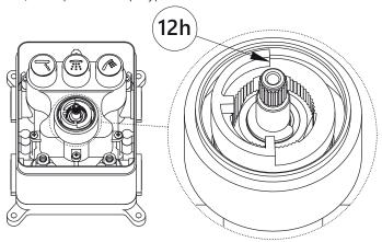
4. Установите ручку так, чтобы кнопка ручки находилась в положении «12 часов» и закрепите её болтиком. Вставьте декоративный колпачок в отверстие ручки.
