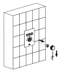
2. На картридже термостата есть 2 отмеченные линии, они должны совпадать. Если повернуть ось картриджа термостата по часовой стрелке – потечёт холодная вода, если повернуть против часовой стрелки – горячая. Чем больше мы поворачиваем против часовой стрелки или по часовой стрелке, тем, соответственно, холоднее или горячее будет течь вода.
