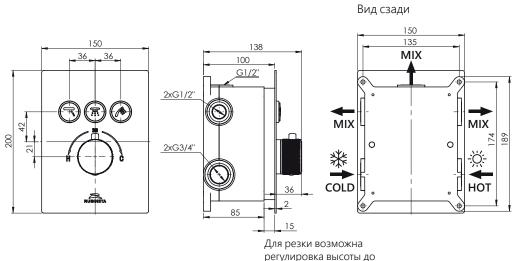
для резки возможна регулировка высоты до 15 мм, которая измеряется и выбирается заказчиком
