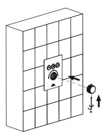
9. Чтобы включить воду, нажмите соответствующую кнопку (см. изображение маркировки кнопок). Чтобы включить холодную воду, поверните ручку термостата по часовой стрелке, а чтобы включить горячую воду – поверните ручку против часовой стрелки, нажав на кнопку на ручке.
