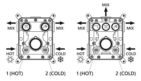
6. Повернув ручку термостата в крайнее положение по часовой стрелке (положение максимальной температуры холодной воды (С)), убедитесь, что течёт холодная вода. Повернув ручку термостата в крайнее положение против часовой стрелки (положение максимальной температуры горячей воды (Н)), убедитесь, что течёт горячая вода (используйте термометр).
