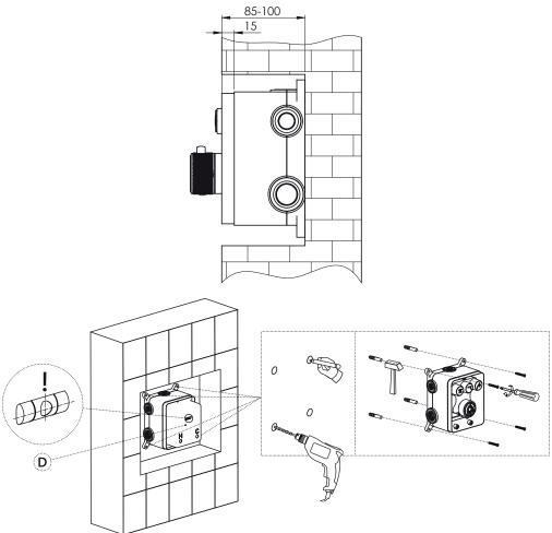
2. Вход горячей воды (на левой стороне смесителя (корпуса) (HOT)) должен быть подключён к системе подачи горячей воды, а вход холодной воды (на правой стороне смесителя (корпуса) (COLD)) должен быть подключён к системе подачи холодной воды. Подключите все выпускные отверстия к отметкам на кнопках головки душа / лейки душа / излива.
